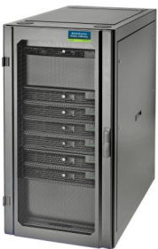
MDL-6000 virtuelle Tape Library mit 6 Nodes und 1.536 virtuellen Drives
